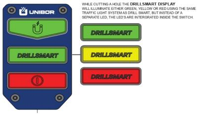
WHILE THE MOTOR IS RUNNING THE **MOTOR ON/OF**F BUTTON WILL ILLUMINATE RED SHOWING THE MOTOR IS READY TO BE TURNED OFF.
